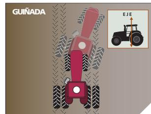
El sistema Autopilot usa sensores T3™ que calculan la posición real del vehículo para minimizar saltos o superposiciones al trabajar en terrenos ondulados y difíciles.
