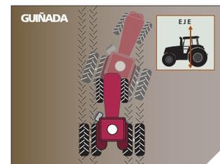
El sistema EZ-Pilot usa sensores T3™ que calculan la posición real del vehículo para minimizar saltos o superposiciones al trabajar en terrenos ondulados y difíciles.
