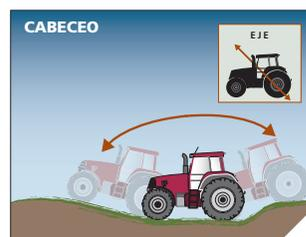
El sistema EZ-Steer usa sensores T2® que calculan la posición real del vehículo para minimizar saltos o superposiciones al trabajar en terrenos ondulados y difíciles.
