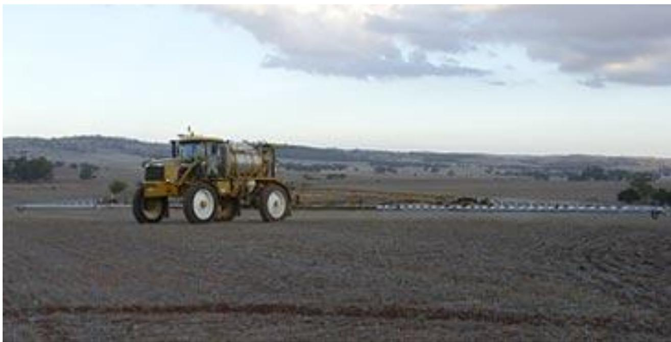
El sistema de detección de malezas y aplicación automática Weed Seeker permite realizar una pulverización inteligente aplicando solamente el agroquímico sobre malezas vivas, a partir de la detección de las mismas mediante el uso del NDVI (Índice Verde Normalizado).-
